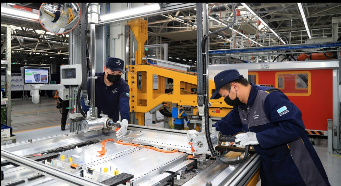
Batteriemontage bei Beijing Benz Automotive Co. Ltd. (BBAC) am Standort Peking.
